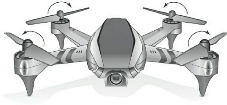
FIGURE 13.1 : Un quadricoptère vole en orientant ses rotors dans les directions qui conviennent.
